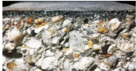
2. Con revestimiento interior de plástico o caucho (Formliners)
